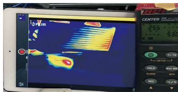
spec.Rサーモグラフ画像...フィンを効率よく使用し冷却している事が確認できた。 冷却>圧損
