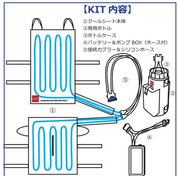
水冷却式冷却シート スペックF
