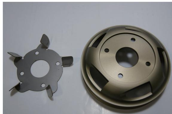
プーリー外径をアップすることにより、高回転時におけるウォーターポンプの過剰回転を抑制し、キャビテーション（泡立ち）を防ぎます。ネーミングはLCは（Low Cavitation）、そして「+α」の部分は、プーリー本体にインナーフィン装着し、風を発生させることでウォーターポンプ自体の冷却とラジエーターシェラウド内の熱気を効率よくエンジンルーム外へ排出させる機能を持たせている事を意味しています。プーリー本体は強靱設計により、アルミプーリーにおいてトップクラスの強度を確保し、ハードアルマイト処理にて更なる強度を確保しています。
