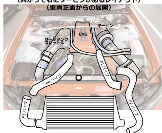
\*パイピングの P1 ~ P4 は、P1 吸込み(タービン側)から順次 P2(コア IN)P3(コア OUT)とレイアウトされ P4 パイピングはサージタンク(スロットル側) の配列となります。
