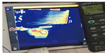
WF/spec.Sサーモグラフィ画像・・・圧力損失が少ないため、コア下部が優先的に冷却されている事が確認できた。 冷却<圧力損失
